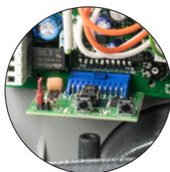
CARTE RADIO RÉCEPTRICE OPEN COLLECTOR
